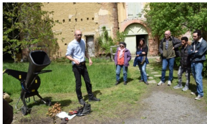
Un broyeur de branches permet de réduire les branchages en petits morceaux valorisables en paillage au jardin ou dans les espaces verts.
